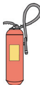
SI. 55. Aparat pod stalnim tlakom za početno gašenje požara prahom. Dijelovi aparata jesu spremnik, ručica za aktiviranje, osigurač, crijevo i mlaznica te često manometar. Na aparatu se mora nalaziti naljepnica s rokom uporabe. Najmanje jednom godišnje aparat provjerava ovlaštena pravna osoba. Spremnik je pod stalnim tlakom od cca 15 bara.
