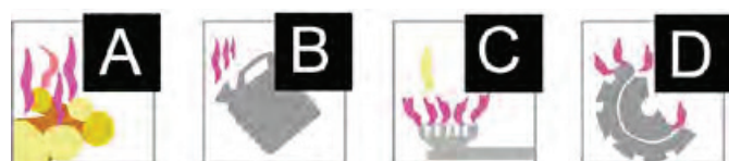
SI. 54. Požar klase «A» je požar zapaljivih krutih tvari. Požar klase «B» je požar zapaljivih tekućina. Požar klase «C» je požar zapaljivih plinova. Požar klase «D» je požar lakih metala.
