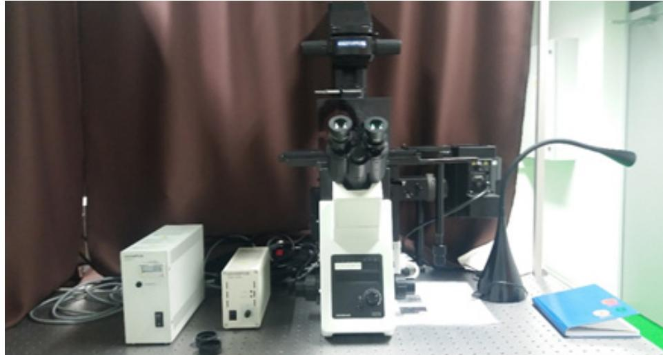
**Kratak opis opreme** Standardni fluorescentni invertni mikroskop koji omogućava ispitivanje fluorescentno obilježenih bioloških uzoraka.
