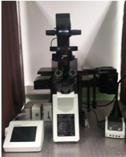
**Kratak opis opreme** Potpuno motorizirani fluorescentni invertni mikroskop koji omogućava brzo i visokoprecizno snimanje fluorescentno obilježenih bioloških uzoraka te akviziciju videosnimaka za praćenje dinamike staničnih procesa (rast, diferencijacija, migracija).
