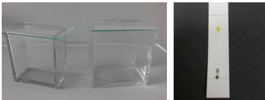
Slika 7. Aparatura za tankoslojnu kromatografiju (a) i kromatogram smjese pigmenata izoliranih iz špinata (b)
